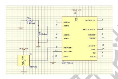
A: AD7705 电路看上去没什么问题。REF192 是 2. 5V 的, 20mA 经过 150ohm 得到的电压 有 3V, 已经超过输入范围了。
